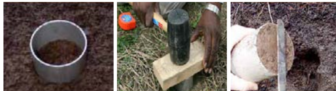
Figura 6.3 Esquema para toma de muestras de densidad aparente de los suelos.
