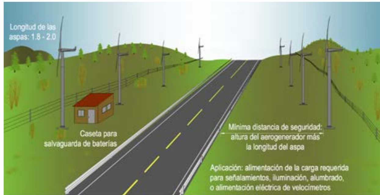
Figura 4.25 Diagrama de diseño de la colocación de las turbinas eólicas en la infraestructura vial.
