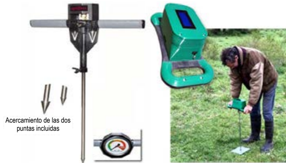
Figura 6.2 Ejemplos de penetrómetros para evaluar la compactación del suelo.
