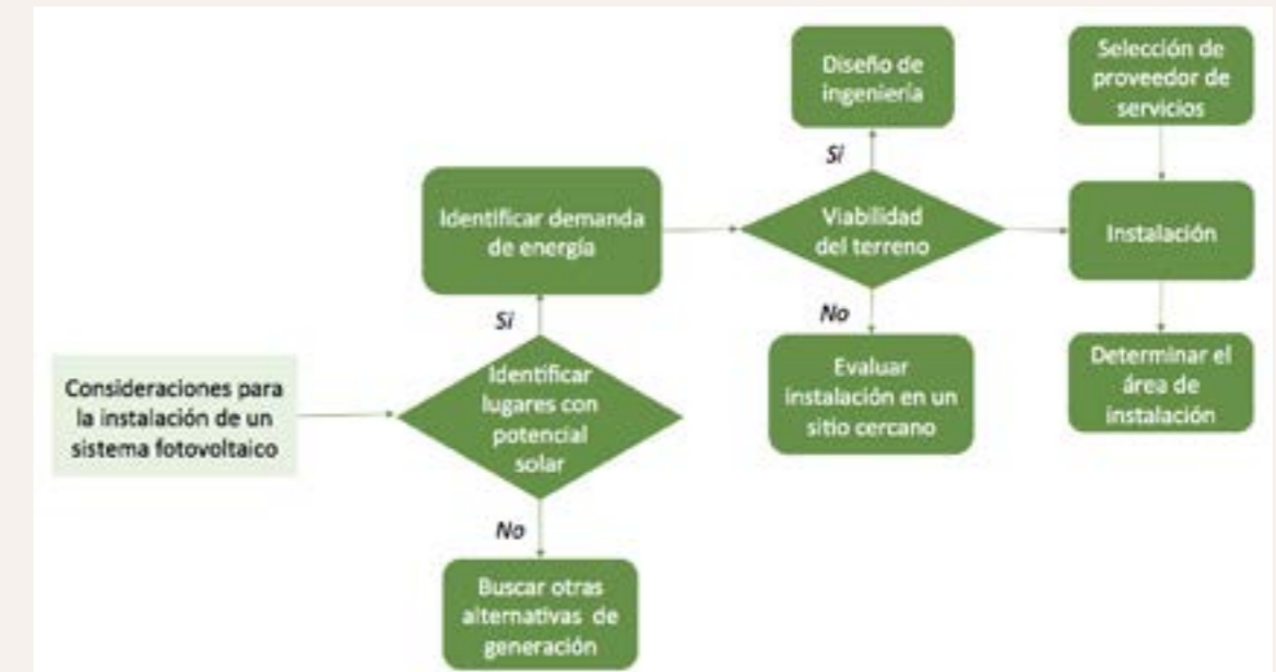
Figura 2.7 Esquema de decisión para las instalaciones de Infraestructura Verde Vial basada en energía fotovoltaica.
