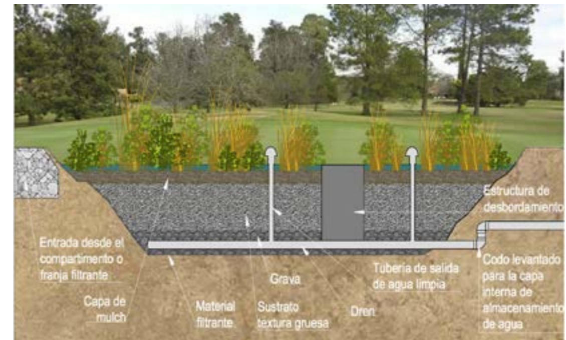
Figura 4.17 Diseño de un biorretenedor de contaminantes.
