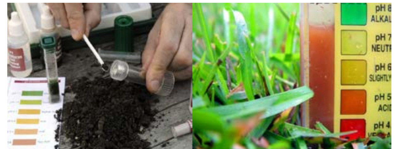
Figura 6.1 Determinación de pH de las muestras de suelo natural y suelos artificiales.
