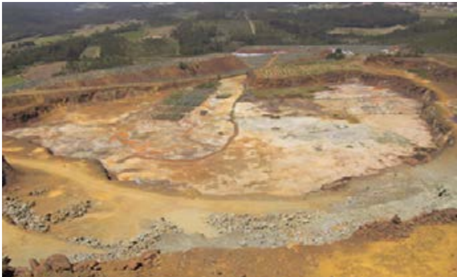
Figura 4.39 Fotografía de zonas mineras restauradas con suelos artificiales a partir de residuos mineros.
