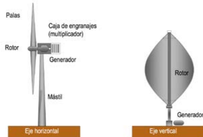
Figura 3.22 Turbinas eólicas de eje horizontal y eje vertical.
