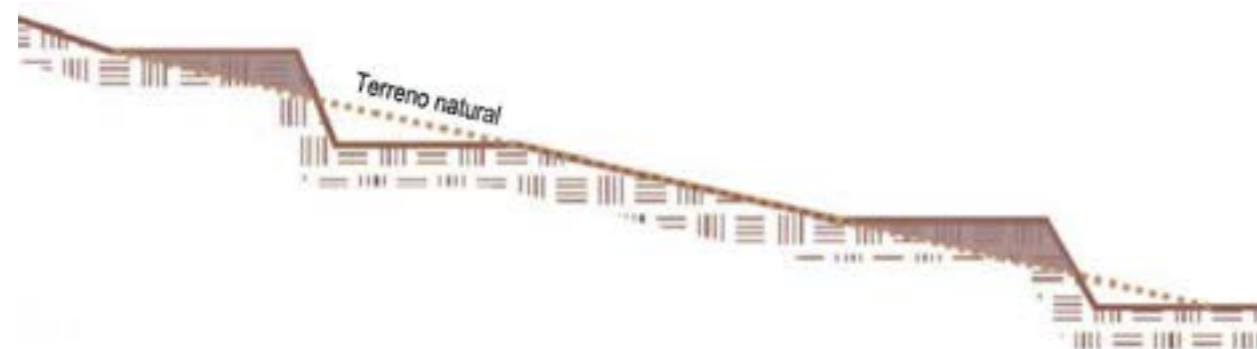
Figura 3.6 Esquema de una terraza de bancos alternos.
