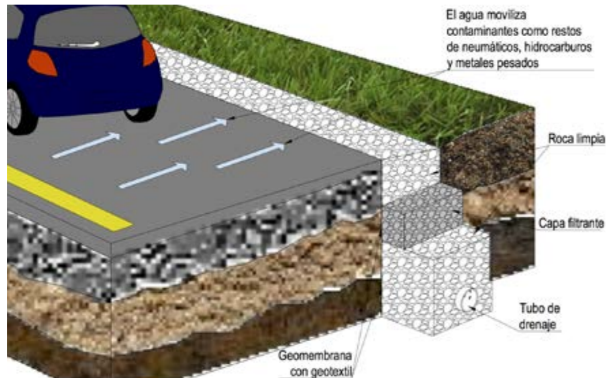
Figura 12 Esquema de cuneta y su conformación.
