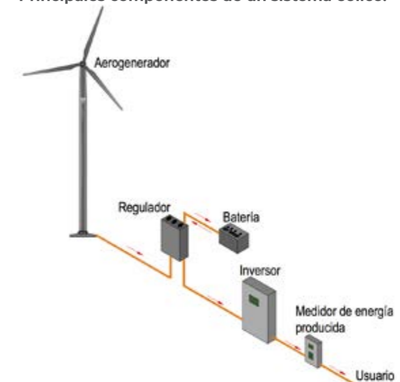
Figura 3.23 Principales componentes de un sistema eólico.
