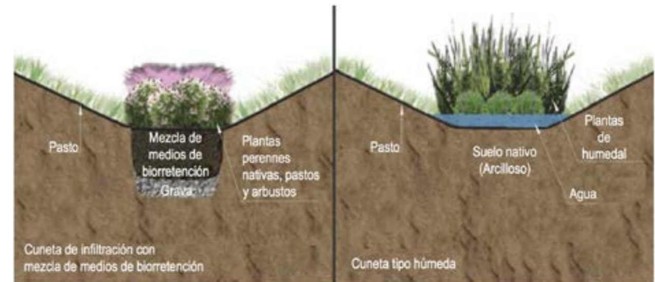
Figura 4.11 Imagen de una cuneta verde tipo húmeda. A la izquierda se muestra una mezcla de suelo mejorado para lograr la retención mientras que en la imagen derecha se observa un suelo nativo de tipo arcilloso.
